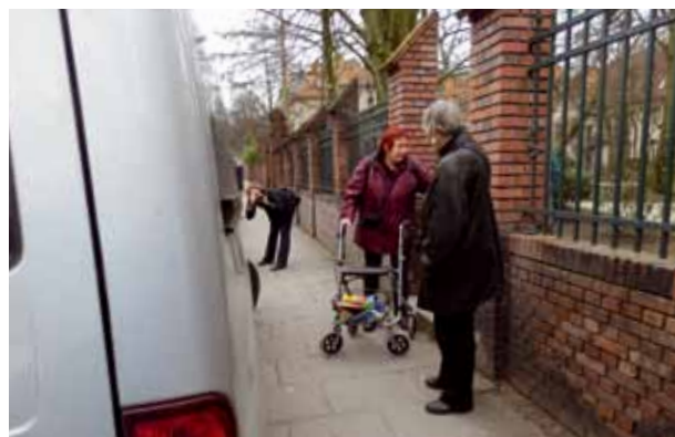
1,20 Meter Gehwegbreite - zu eng für Mensch und Rollator
